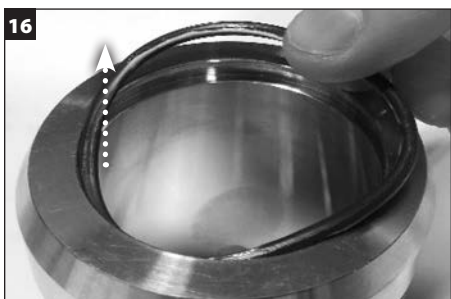
16 Fjern akselens o-ring (V) fra hylsen og avhend.
