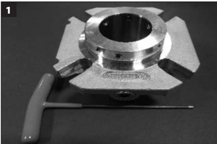
1 Verktøy som kreves for demontering av tetningen: Unbrakonøkkel (levert med tetningen); pinsett og en krom pirk (levert av kunden; for fjerning av o-ringer og drivrør).
