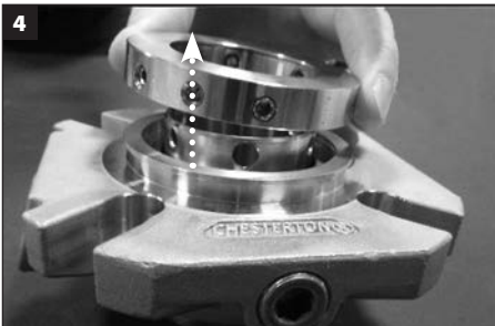
4 Fjern låseringen fra fra hylsen og sett den til side.
