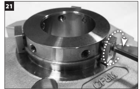
21 Installer sentreringsklemmene på den ytre diameteren til låseringen med sentreringsklemmenes flate hodeskrue.
